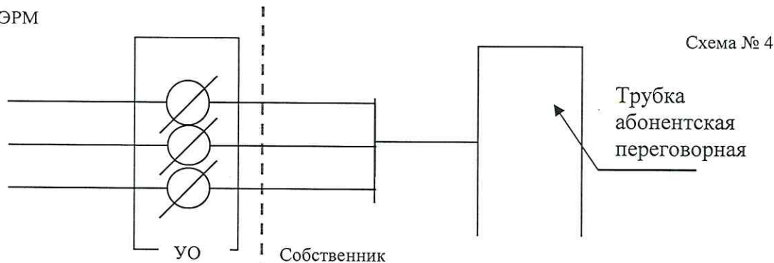
Граница раздела обслуживания по переговорному устройству домофона между Управляющей организацией и Собственником помещений
